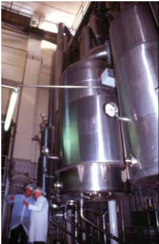
Obersteirischen Molkerei / Knittelfeld, Verdampfer zur Herstellung von Molkepulver
