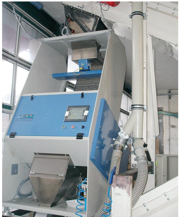
Abb. 4: Farbsortiererei zur Verarbeitung von Bio-Sonnenblumenkernen bei der Firma Kramerbräu Agro & Food GmbH, Pfaffenhofen/Ilm (Maschinen- und Ingenieurbüro Barthel)
